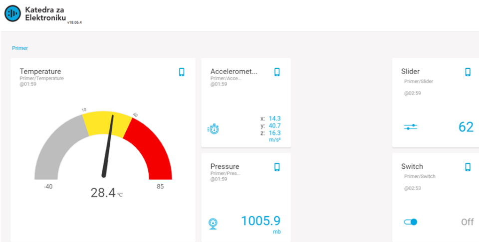
Slika 4. Primer vizualnog prikaza podataka na platformi IoT-elektronika
