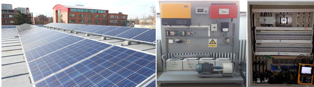
Slika 4. Fotonaponska elektrana (levo), laboratorijski model vetrogeneratora (u sredini) i ilustracija postupka snimanja parametara kvaliteta električne energije upotrebom savremenog mernog uređaja (desno)
