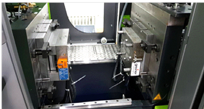
Slika 3. Alat za izradu priveska, donacija kompanije Greiner Packaging iz Nove Pazove
