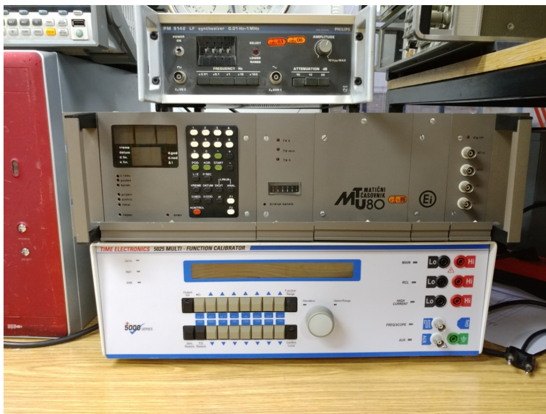
Slika 4. Generatori frekvencije: Philips PM5142, Matični časovnik MTU-80, multifunkcijski kalibrator Time Electronics 5025
