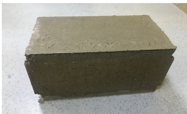
Slika 5. Izgled blokova za zidanje pripremljenih za ispitivanje čvrstoće pri pritisku
