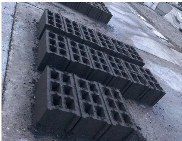
Slika 4. Izgled spravljenih prefabrikovanih blokova za zidanje
