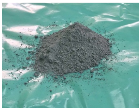
Slika 2. Izgled pepela pšenične slame nakon prosejavanja i mlevenja
