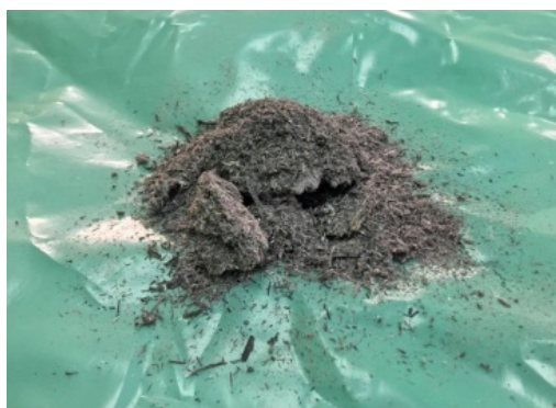
Slika 1. Izgled pepela pšenične slame pre pripreme
