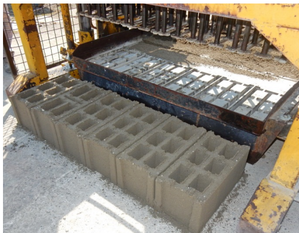
Slika 3. Ugrađivanje blokova za zidanje pomoću vibroprese
