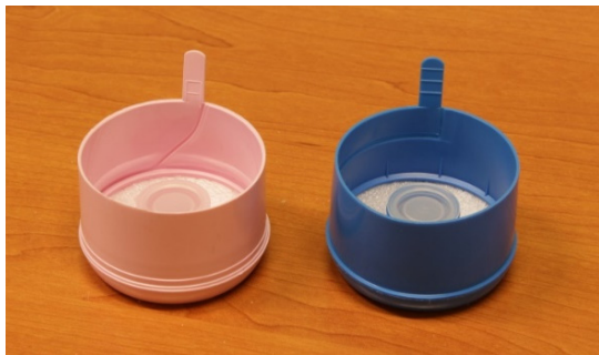
Slika 2. Postojeći (levi, rozi) i unapređeni (desni, plavi) plastični zatvarač
