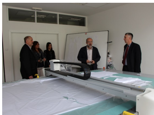
Slika 5. CAM – računom vođena mašina za iskrojanje tekstila francuske kompanije Lectra
